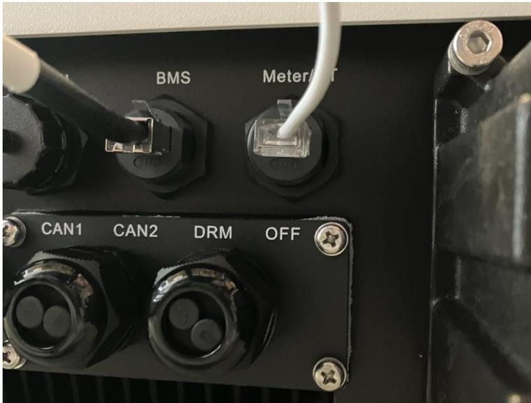
Verkabelung des Ethernet Kabels am "USB zu RS485" Adapter angesteckt am SolarstromHero:
