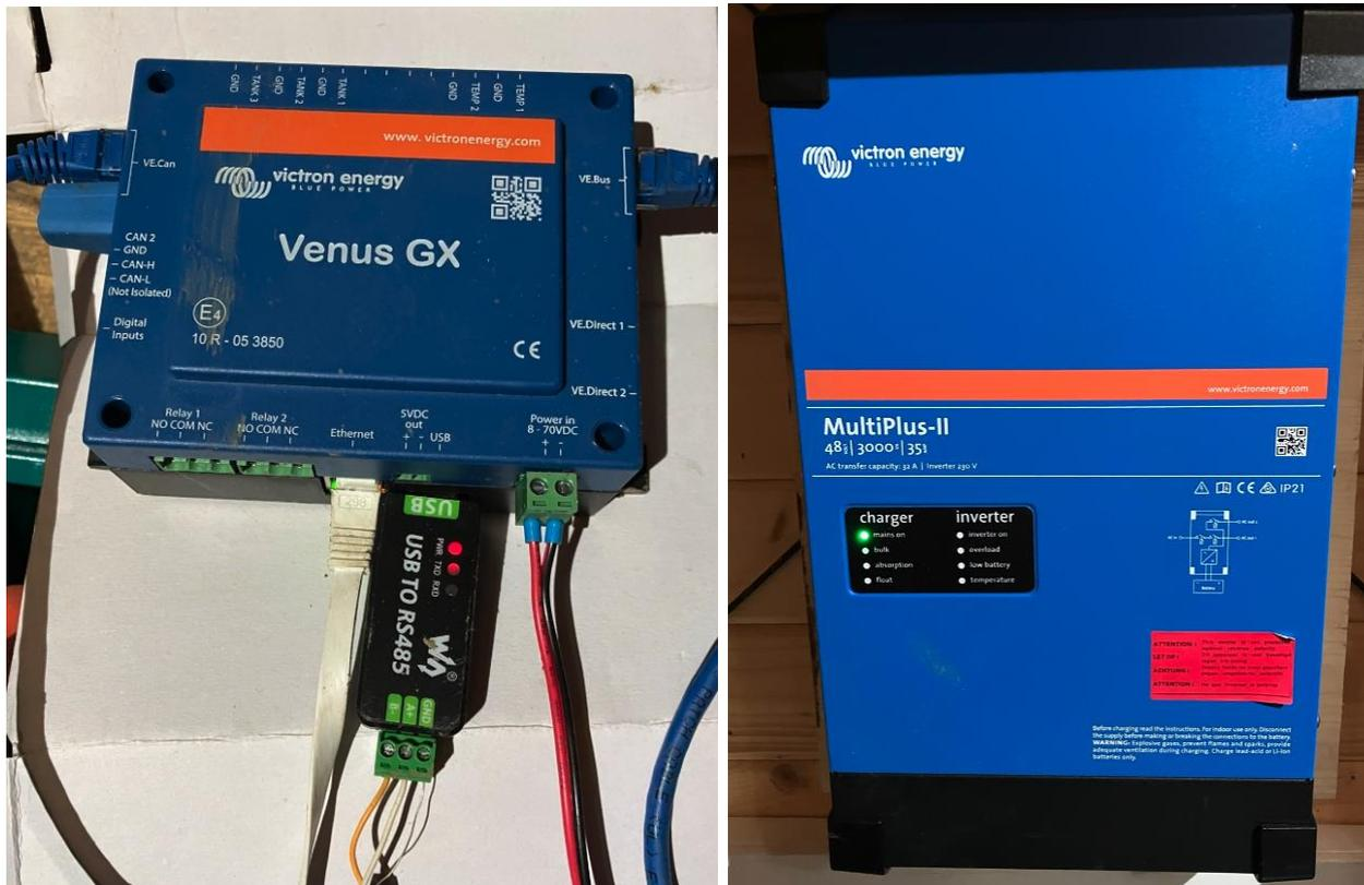
Anschluss am USB TO RS485 Stecker am SolarstromHero:
